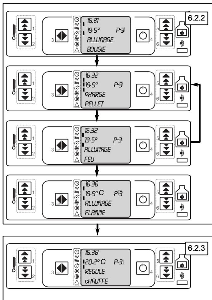
Les commandes automatiques ou saisies par l'utilisateur (puissance, température) sont actives (fig. 6.2.3) lorsque la phase d'allumage est terminée (15 min. environ).
