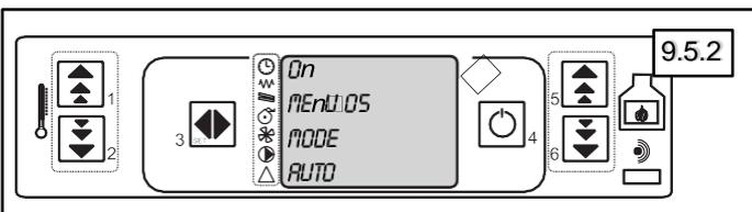
Mode AUTO : fonctionnement économique. Le poêle s'éteint après un délai de quelques minutes (cf § 6.4 Extinction) lorsque la température de consigne est atteinte (cf § 9.5) et se rallume automatiquement lorsque la température ambiante est inférieure à la température consigne (- 2°C).
