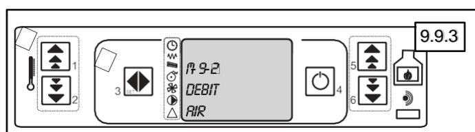
Lors de la mise en service (cf § 4.6; logigramme 3.A), ou si la combustion est fortement modifiée en changeant de type de granulés (nouvelle marque, nouvel approvisionnement), modifier la valeur diminue (-) ou augmente (+) le débit d'air de combustion par pas de 3.
