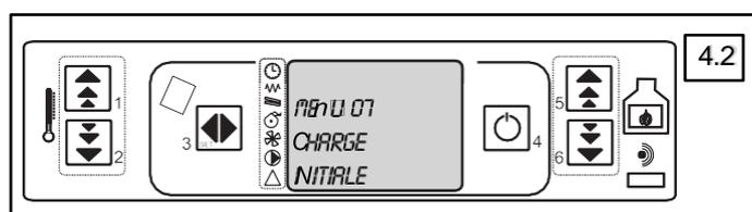
Effectuer le chargement initial de la vis d'alimentation (cf Menu CHARGE INITIALE § 9.7). Arrêter le chargement de la vis sans fin lorsque les granulés tombent dans le brûleur. Si le brûleur contient des granulés avant l'allumage, vider le brûleur.
