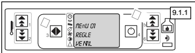
Sélectionner le débit du ventilateur 2 (VENTIL-2) de 0 à 5; ou "A" (Automatique) pour ajuster le débit de ventilation à la puissance de chauffe (P1-P5). Pour les puissances de chauffe élevées (P4; P5) sélectionner la ventilation automatique (A) pour éviter les alarmes de température (AL3; AL7).
