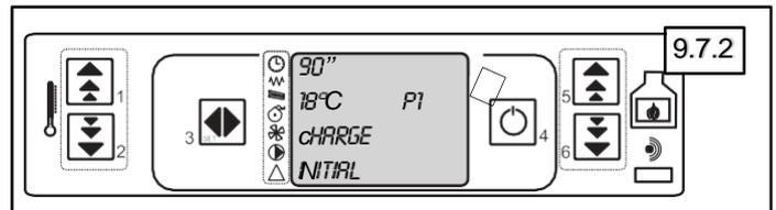
Le chargement de la vis sans fin s'arrête automatiquement après 90 s, mais il est préférable d'arrêter le chargement lorsque les pellets tombent dans le brûleur (appuyer sur "4"). Retirer les pellets du brûleur. Le poêle peut être allumé (§ 6.2.1).
