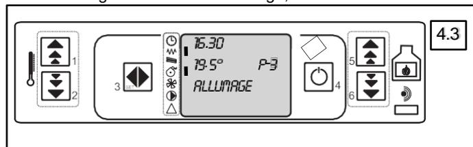
Activer l'allumage manuel (cf § 6.2.1), (dure environ 15 minutes et ne doit pas être interrompu), la fumée précédant les flammes est causée par l'allumage des granulés.
