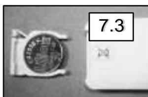
Télécommande remplacement de la pile 3V CR2025
