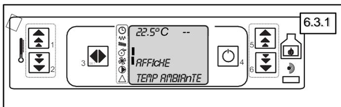
Le poêle régule la puissance pour maintenir la température mesurée au niveau de la température de consigne. Le poêle fonctionne jusqu'au prochain changement de mode ou jusqu'à la prochaine commande d'extinction.
